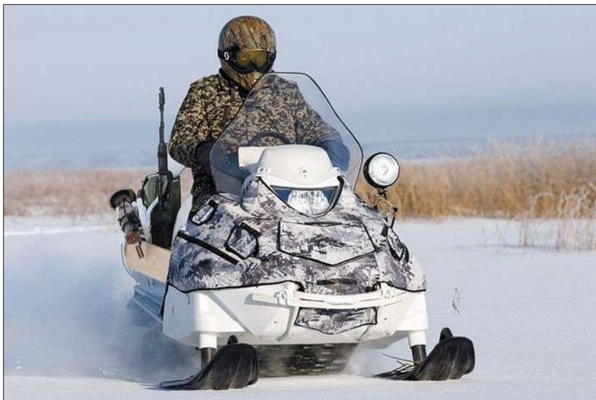
Рисунок 3. Армейский снегоход А1, предназначенный для эксплуатации в Арктической зоне
