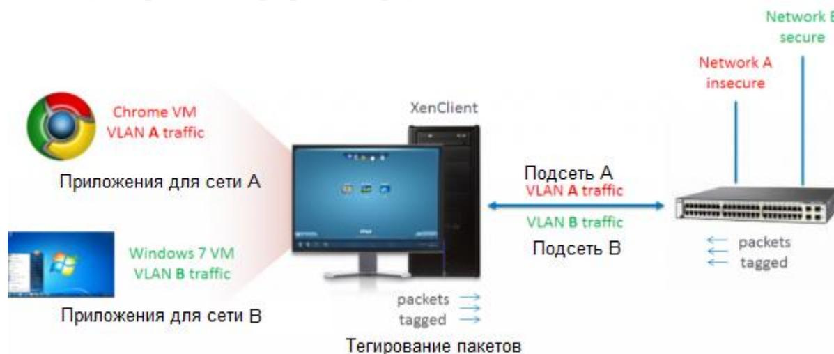
Рисунок 1 - Схема работы Citrix XenClient XT
