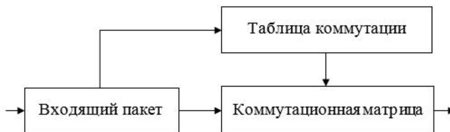
Рисунок 1 - Передача данных в Ethernet коммутаторе
