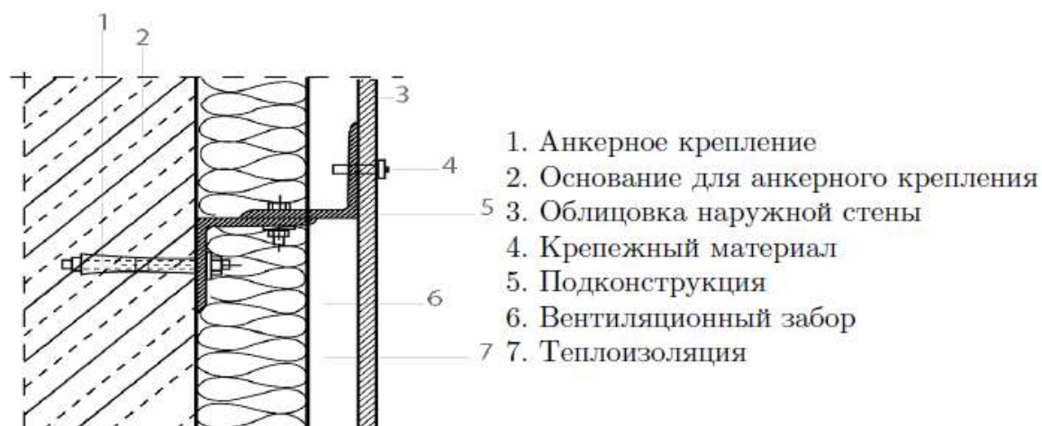
Рисунок 2 – Конструкция наружной стены с использованием вентилируемого фасада [8]
