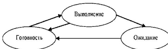
**Рисунок. 2. Граф состояний процесса**
