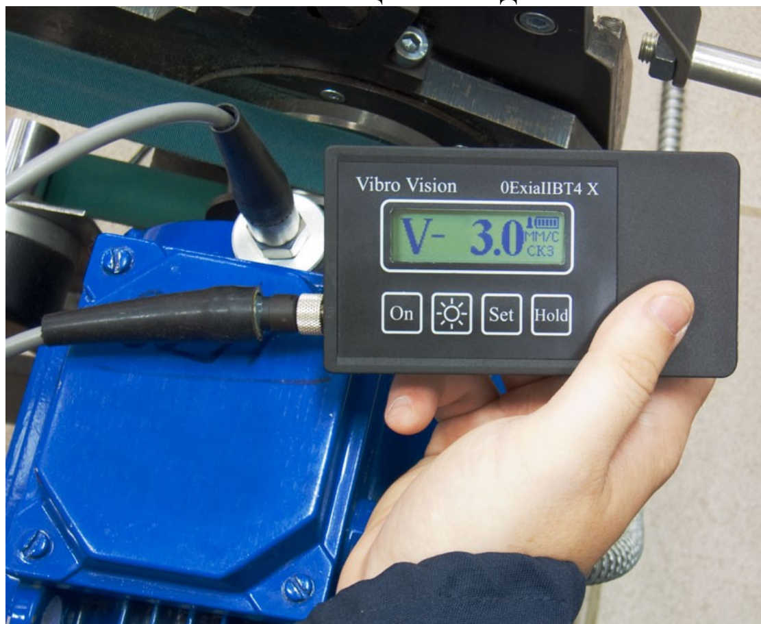
Рисунок 1. Снятие показаний вибрации на электродвигателе Источник: http://mhs-perm.ru/s3.html
