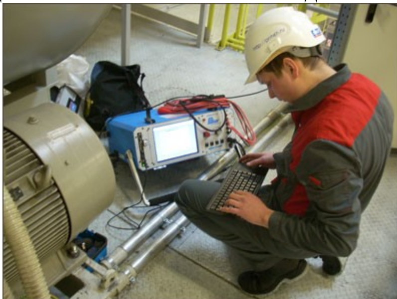
Рисунок 2. Снятие параметров тока с электродвигателя
