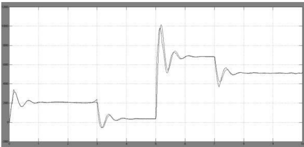
Рисунок4. График сравнения тока модели электропривода и нейросетевой модели.
