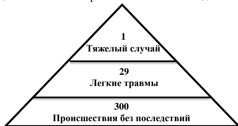
Рисунок 1 «Треугольник несчастных случаев» по теории Хенриха Для анализа представим диаграмму по оценке степени тяжести полученных работниками АО «ДРСК» травм за 2014-2018 гг. на рисунке 2.
