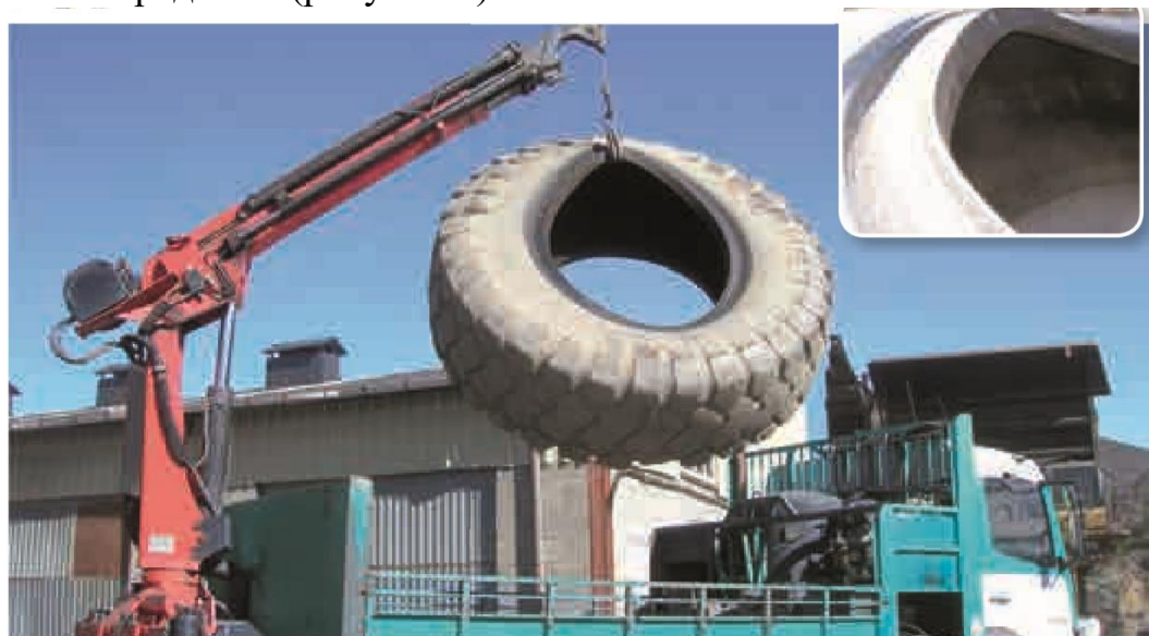
Рисунок 5 – Неправильная погрузка КТШ
