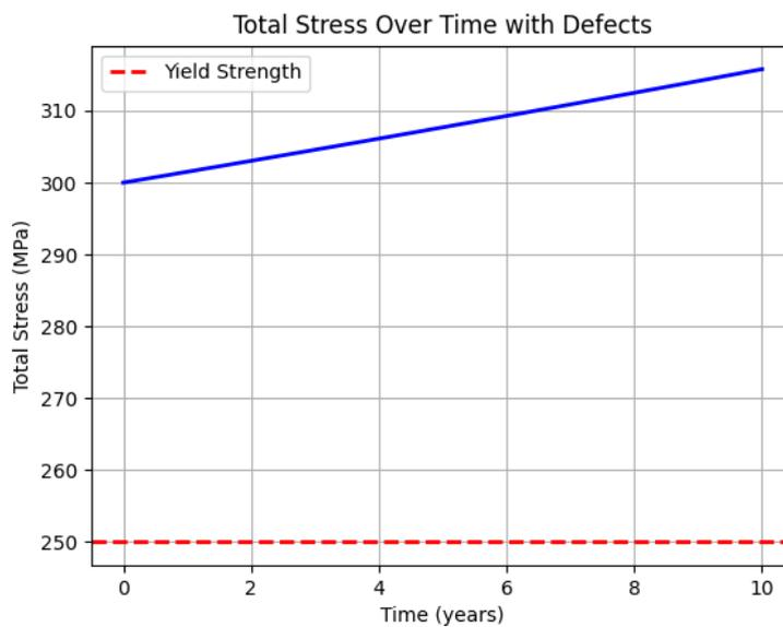
Рисунок 7 – Карта критических параметров суммарных напряжений с дефектами
