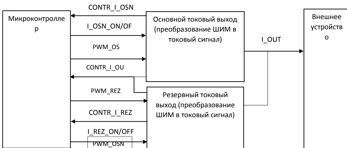
Рисунок 1 – Резервирование токового выхода газоанализатора
