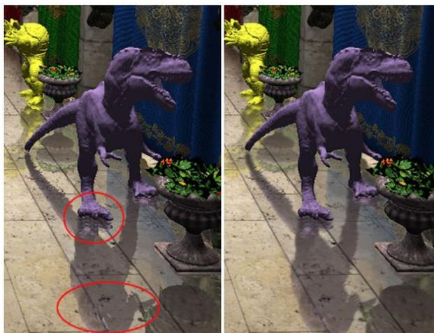
Рисунок 9. Слева гибридное изображение и визуальные артефакты (выделены кружком), которые могут появиться из-за процесса слияния SSR и трассировки лучей. Справа артефакты были уменьшены путем применения размытия Гаусса[23]
