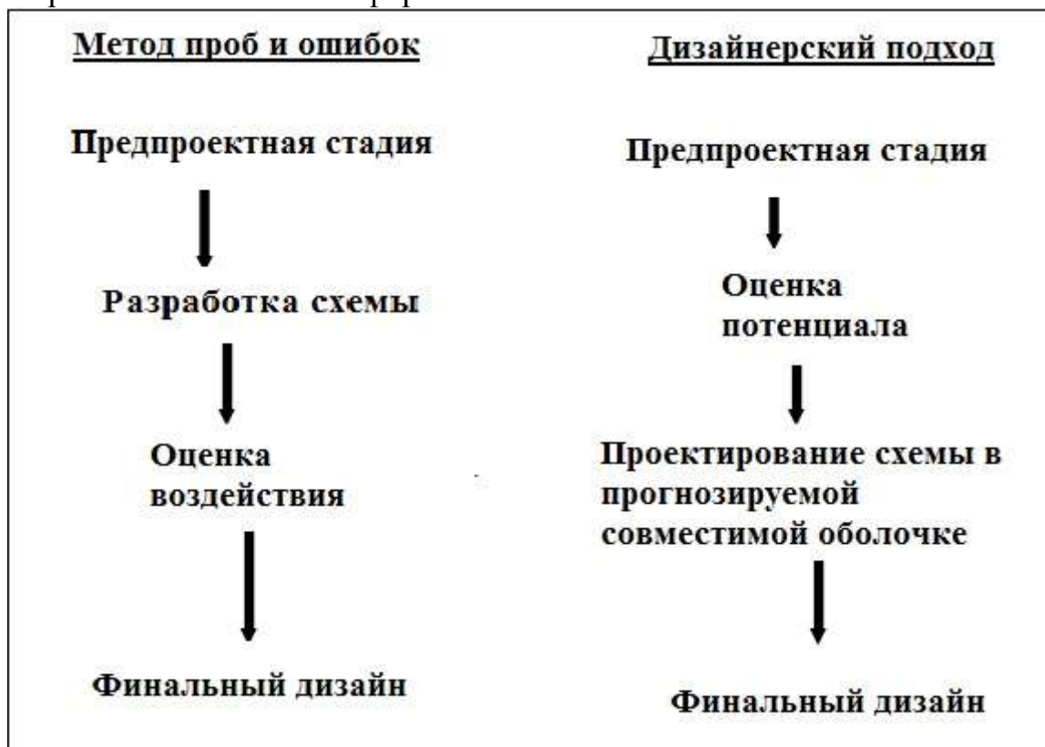
Рисунок 8. Метод проб и ошибок для оценки солнечной радиации в городах и предлагаемый подход к проектированию.
