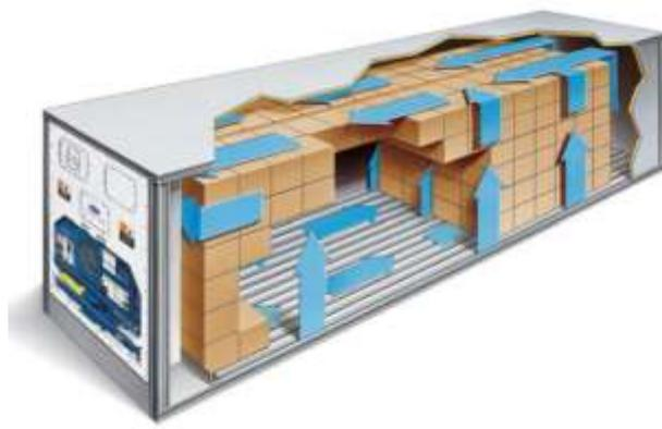
Рис.1 Размещение груза в кузове
