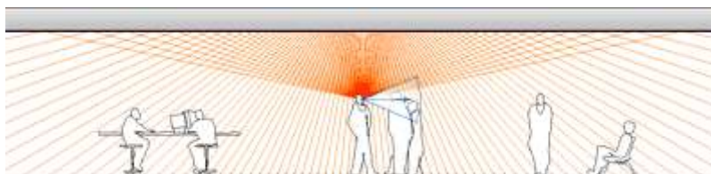
Рисунок 1: Влияние плоского потолка на отражение звука. Низкая высота потолка плюс большая открытая площадь пола могут создать эффект акустического туннелирования, что приведет к увеличению шумов и громкости.
