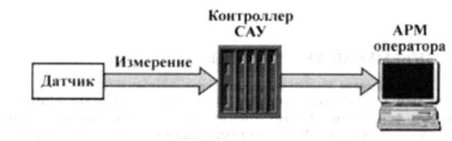
Рисунок 1. Схема прохождения сигнала от датчика к ЭВМ оператора
